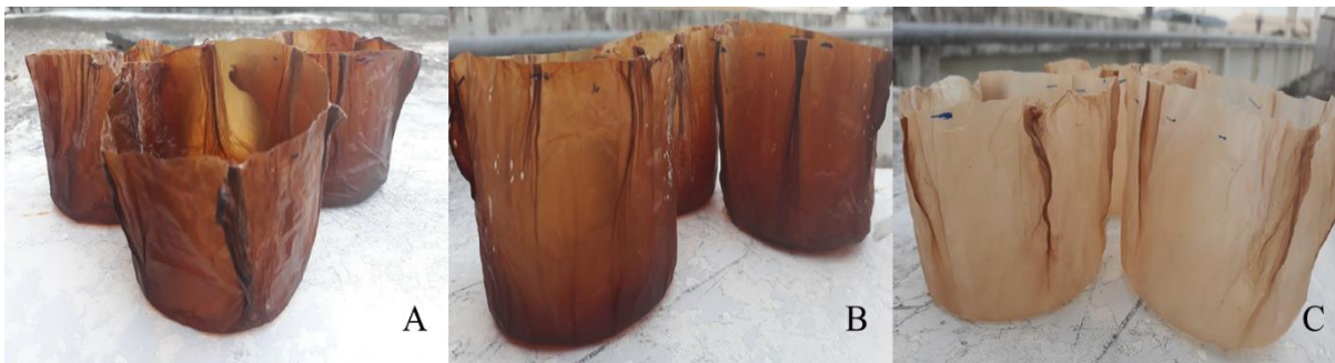
ภาพที่ 3 กระดาษที่ทำจากแบคทีเรียเซลลูโลสที่ผลิตจากเชื้อ Komagataeibacter nataicola TISTR 975 โดยใช้อาหารที่เตรียมจากวัสดุเหลือใช้ทางการเกษตร ในสถานะหนึ่ง ที่อุณหภูมิห้อง ( 28 \pm 2 องศาเซลเซียส) เป็นเวลา 10 วัน (A: แบคทีเรียเซลลูโลสจากน้ำมะพร้าวแก่ B: แบคทีเรียเซลลูโลสจากน้ำคั้นเปลือกแตงโม และ C: แบคทีเรียเซลลูโลสจากน้ำคั้นซังข้าวโพด)
