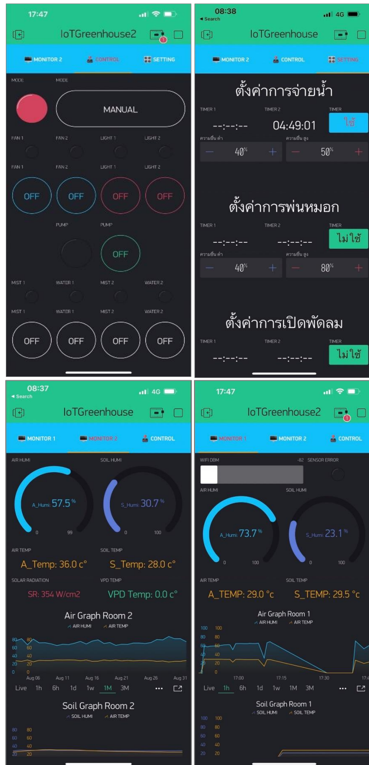
ภาพที่ 6 หน้าหลักบนหน้าจออุปกรณ์มือถือเมื่อเปิดเมื่อเปิดแอปพลิเคชัน Smart farm และหน้าจอ Monitor เพื่อแสดงค่าข้อมูลของแต่ละฟังก์ชัน
