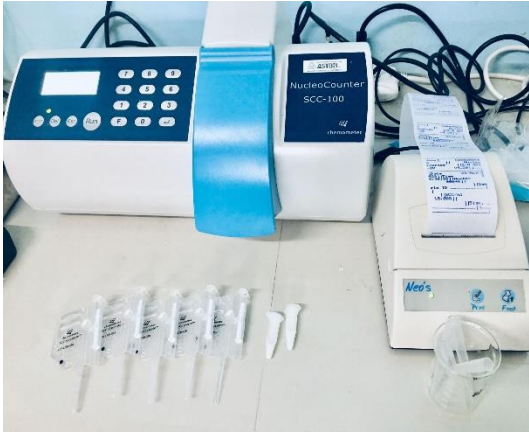
ภาพที่ 7 เครื่องมือวิเคราะห์ปริมาณเม็ดเลือดขาว
